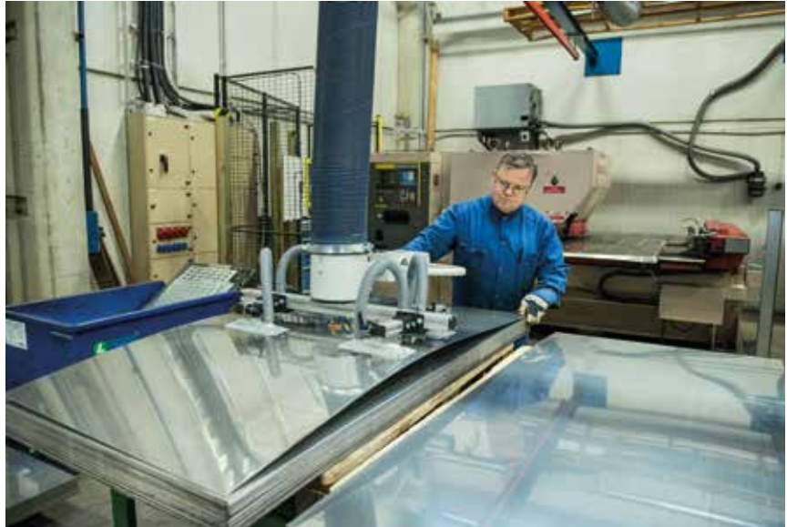
Keventäjä tekee isojenkin levyjen käsittelystä helppoa. Valmiiden levyjen pinosta saadaan myös hyvin siisti.
