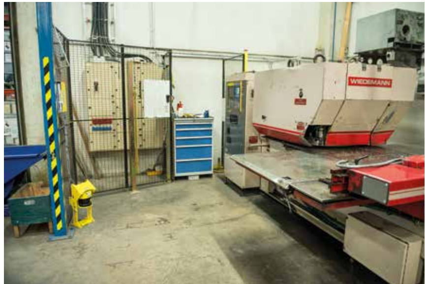
Lattiaan kiinnitettynä turva-aidan vieressä on SICK-laserskanneri, joka valvoo koko työskentelyaluetta neljällä eri tavoin reagoivalla valvontakentällä.
