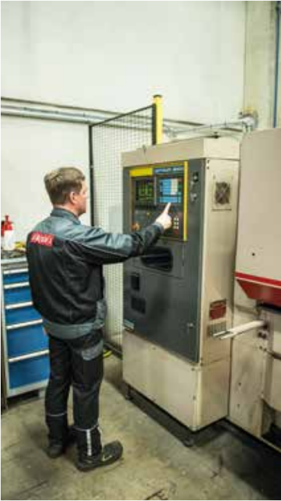
Laserskannerin valvonta-alueessa on levytyökeskuksen ohjaustaulun edessä kenttä, joka sallii koneen toiminnan, vaikka käyttäjä on siinä ohjelmoimassa koneen toimintaa.
