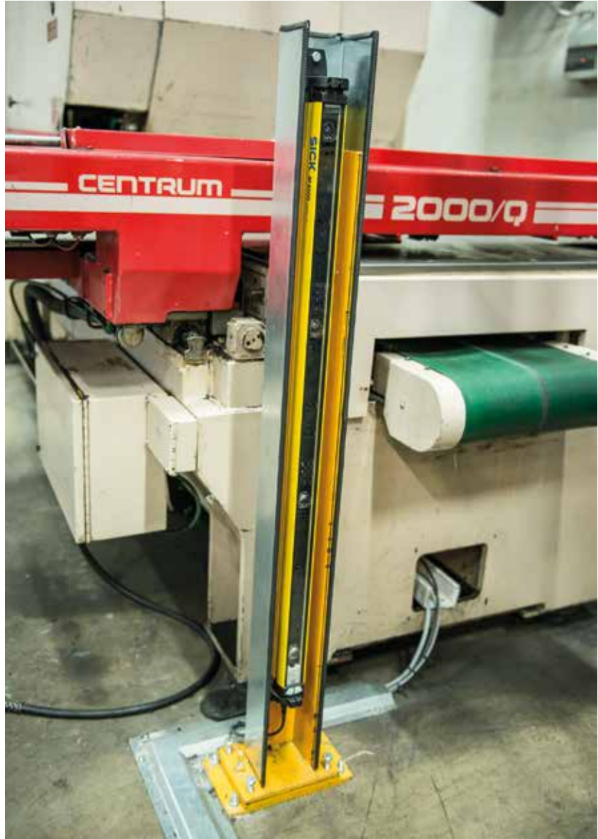
SICK-valopuomi on yksinkertainen turva-anturi, joka estää koneen käynnistämisen, jos joku on mennyt sen taakse. Poistuminen valvotulta alueelta pitää myös kuitata painikkeella.
